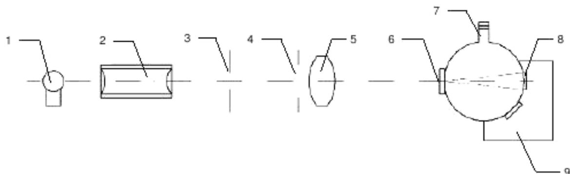
1 – источник света, 2 – коллиматор, 3 – входная диафрагма, 4 – апертурная диафрагма, 5 – линза, 6 – образец, 7 – фотометр, 8 – световая ловушка, 9 – отражающий стандартный образец.
