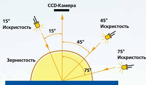
Снимки анализируются с помощью гистограммы уровней светлоты отдельных пикселей в качестве базовой информации. Равномерность светлых и темных зон суммируется в одном значении зернистости. Значение зернистости, равное нулю, будет указывать на простой цвет. Чем выше значение, тем более зернистым или неравномерным будет выглядеть образец под диффузным освещением.
